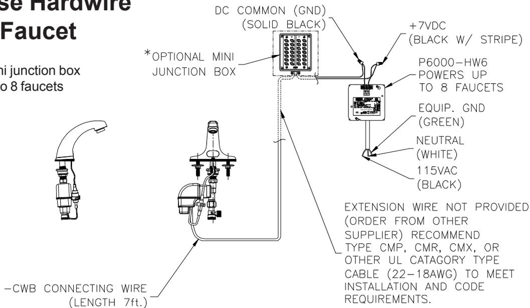
NOTE: MUST USE EITHER ZURN P6000-HW6 HARDWIRE POWER CONVERTER OR ZURN P6000-PC6 PLUG-IN POWER CONVERTER TO ENSURE PROPER OPERATION. USING A POWER CONVERTER OTHER THAN ZURN MAY RESULT IN OPERATION MALFUNCTION OR UNIT FAILURE.
